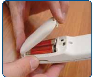
Fig. 4.1: Cambiar las pilas de las estaciones de llamada y envío.
